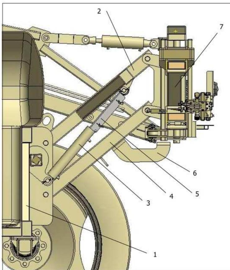
1 - Рама; 2 - Верхний рычаг; 3 - Гидроцилиндры подъема; 4 - Нижний рычаг;
