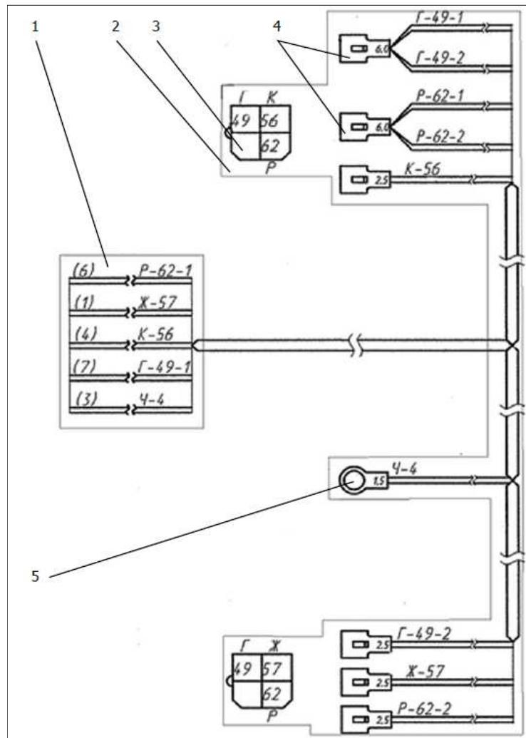
1 - Вилка; 2 - Проводка фонарей задних; 3 - Колодка гнездовая; 4 - Гнездо; 5 - Наконечник
