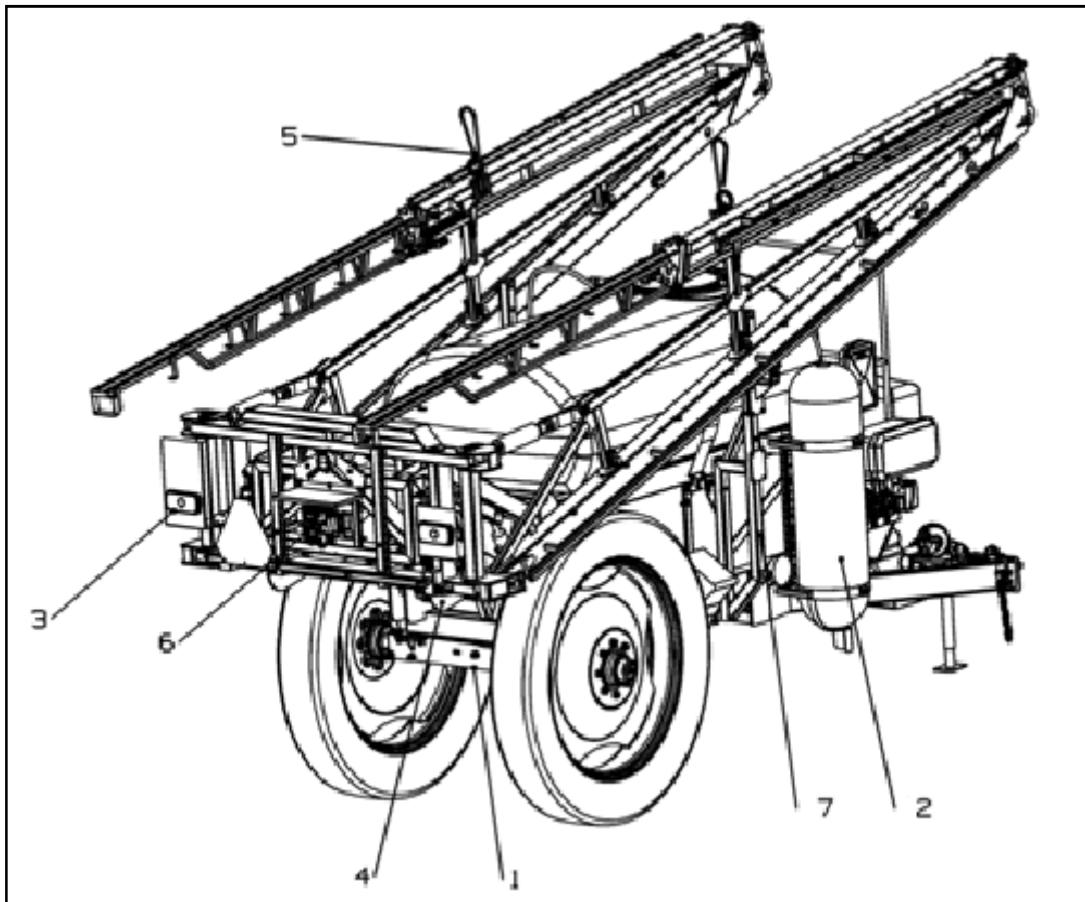
1 - Мост; 2 - Промывочная емкость; 3 - Стоп-сигнал и боковой повторитель;
